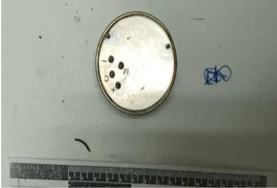
Рисунок 4 Контакти елемента живлення ЕАР-12081
